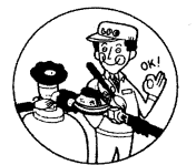
検知液で漏れの有無を確認する
