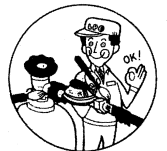
検知液で漏れの有無を確認する
